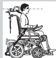
El «maniquí de la prueba de colisión» se sujetó con un cinturón de seguridad para la zona pélvica y otro para la parte superior del cuerpo. Deberán utilizarse ambos tipos de cinturones de seguridad para reducir al mínimo el riesgo de sufrir lesiones en la cabeza y en la parte superior del cuerpo.
