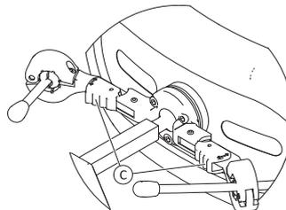
1. Presione el dispositivo de bloqueo **C** (detrás del reposacabezas) y gire el joystick o el interruptor con forma de huevo hacia dentro o hacia fuera hasta que encaje en su lugar.
