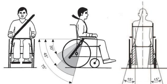
El cinturón pélvico debe colocarse en el área entre la pelvis y los muslos del usuario, de modo que no quede obstruido ni demasiado suelto. El ángulo ideal del cinturón pélvico con respecto a la línea horizontal es de entre 45° y 75°. El ángulo máximo permisible es de entre 30° y 75°. El ángulo no debe ser nunca inferior a 30°.
