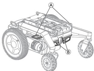
La silla de ruedas eléctrica se puede equipar con puntos de sujeción **A** adicionales para facilitar el acceso.
