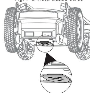
La placa de bloqueo (2) debajo de la silla de ruedas eléctrica ayuda a guiar la silla de ruedas eléctrica en la estación de acoplamiento Dahl.
