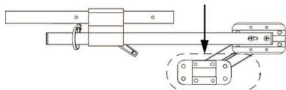
Para que el mando recupere la posición extendida normal, empuje hacia afuera en la superficie interna del mando, luego hacia adelante y adentro hasta que el eslabón de cuatro patas se mueva su rango completo y haga clic en su posición completamente extendida.
