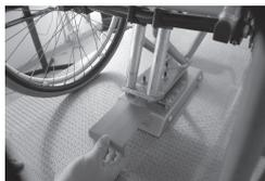
Coloque la herramienta de liberación de emergencia en el espacio entre la placa de bloqueo y la estación de acoplamiento Dahl.
