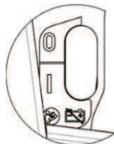
1. Para desconectar la alimentación manualmente, mueva el interruptor del disyuntor **B** hacia arriba.
